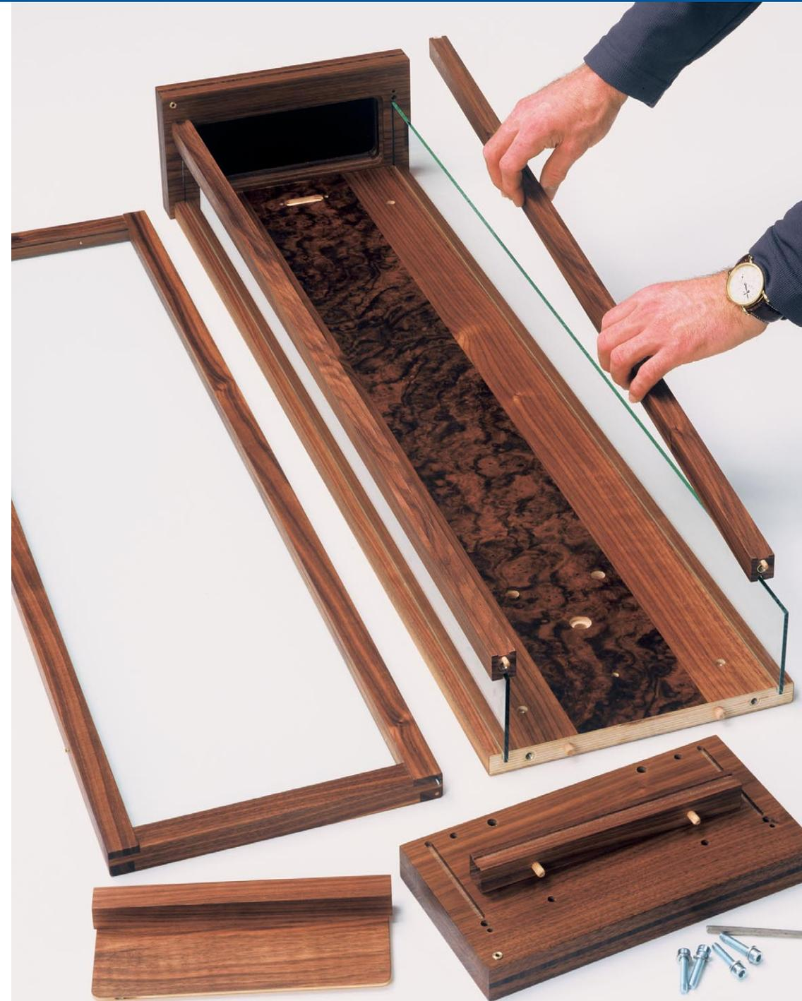
Beginnen Sie die Montagearbeit mit dem Gehäuse. So können Sie später die fertig montierten Uhrwerksteile gleich in das schützende Gehäuse einbauen.
