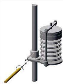
Bei Doppelzylinder- und Linsenpendel befindet sich das Barometerinstrument zwar auf der gleichen Position, ist aber mit unterschiedlichen Auflagegewichten versehen. Als Bezugsfläche zum Messen dient dabei jeweils die obere Kante des Anschraubflansches (siehe Abbildungen). Die Verschraubung soll sich auf der Seite der Pendelhakenöffnung, im Gehäuse also der Rückwand zugewandt befinden.
