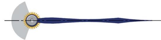
Der Inbusschlüssel Schlüsselweite 0,9 mm kann Ihnen hierbei eine Hilfe sein, wenn Sie diesen in die erst lose ins Gewinde geschraubte Inbus-Madenschraube M2 x 2 stecken. Dieser muss genau unter dem Zeiger stehen.
